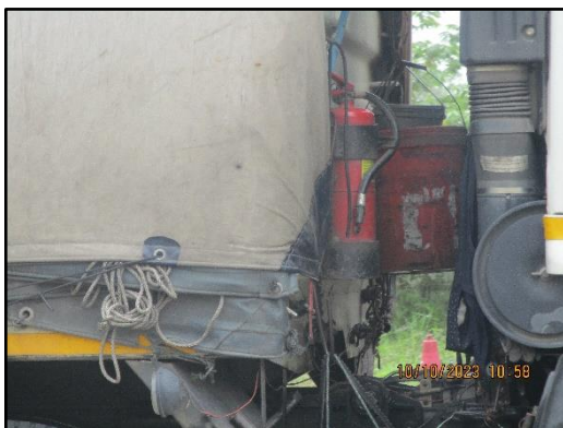
ภาพที่ 2.50 ถังดับเพลิงบนรถบรรทุกสินค้า
